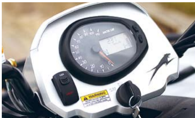
To vlevo vedle budíku je tlačítko zámku přední špéry, jištěné pojistkou
